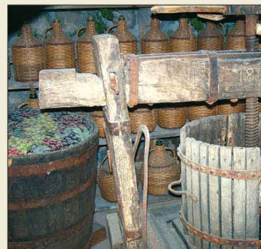
Quetschen, bis der Rebensaft läuft: (Weinpresse, Meteorenklöster, Griechenland, 19. Jahrhundert): Mit Pressen wie dieser machten sich schon die antiken Griechen die Schraubtechnik zunutze. PbK
