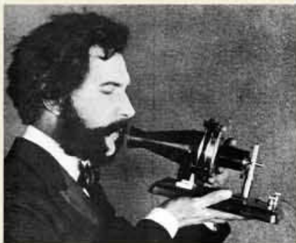
Fernsprecher der Stunde null: Bei der Erfindung Alexander Graham Bells (1847-1922) waren Sender und Empfänger dasselbe Teil. Es bestand aus einer biegsamen Metallmembran und einem Hufeisenmagneten. Die Sprache wurde über Schwankungen in der Stromstärke übertragen (prinzipiell funktioniert das Telefon heute noch so). Zum Telefonieren musste man die Muschel abwechselnd an Mund und Ohr halten. Foto: Early Office Museum
