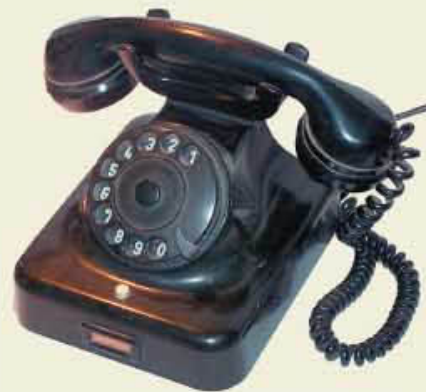
Baureihe W 38: Siemens & Halske stellte diese Apparate ab 1938 her. Die Nummernwählscheibe ist eine Erfindung des Franzosen Antoine Barnay, die er sich 1923 patentieren ließ. Foto: PhK
