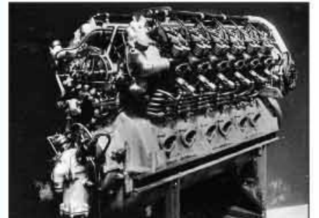
Maybach-Motoren: Die mit fünf dieser je 400-PS-starken Kraftpakete ausgerüstete LZ 126 (1924) schaffte 126 Kilometer in der Stunde.
